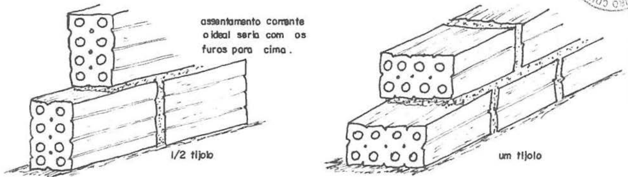
Figura 1 - Execução de alvenaria utilizando tijolos furados.
