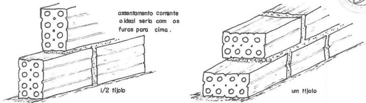
Figura 1 - Execução de alvenaria utilizando tijolos furados.
