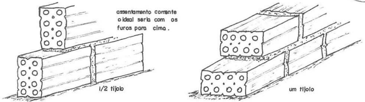
Figura 1 - Execução de alvenaria utilizando tijolos furados.
